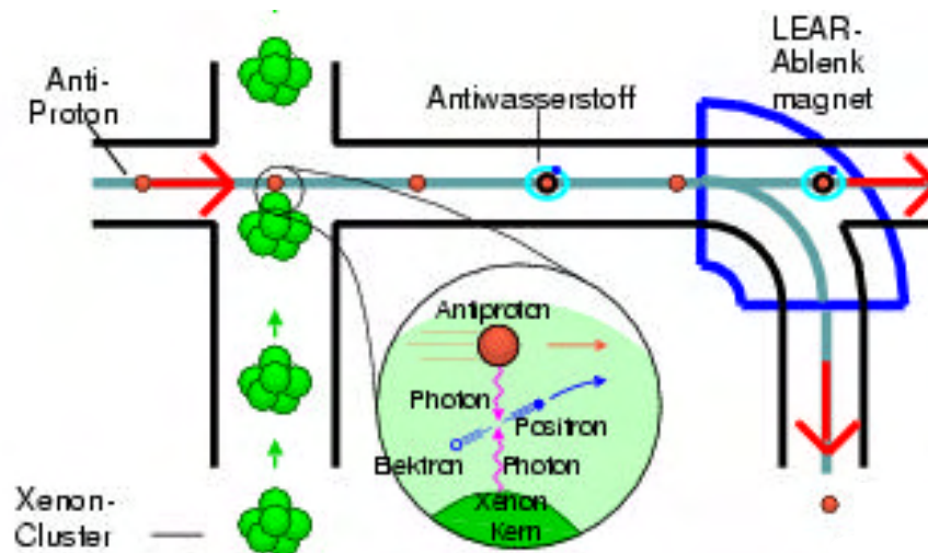
Abb. 7: Schematische Darstellung der Antiwasserstoff-Erzeugung am LEAR
